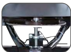
Disque et palettes en acier inoxydable
