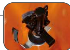
Agitateur à chaînes et masselottes
