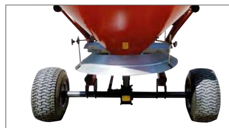
Limiteur d'épandage en acier inox
