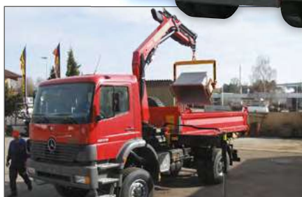
Bascule du bac à sel pour vider le contenu
