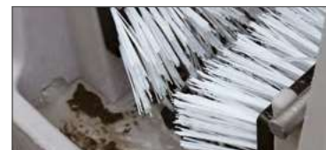
Bac de récupération des eaux usées
